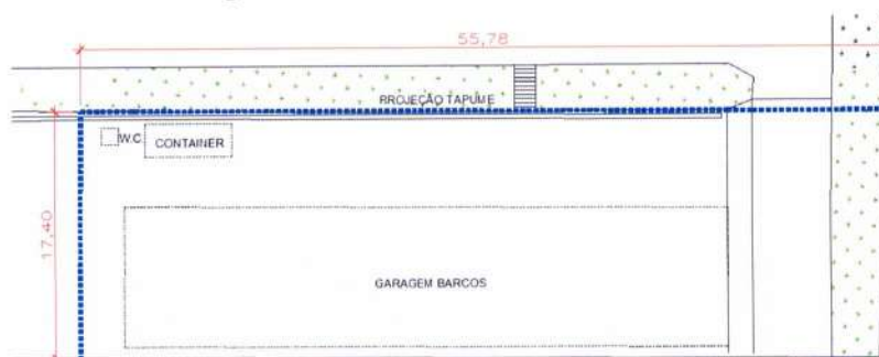
Figura 05 – Indicação localização tapume
